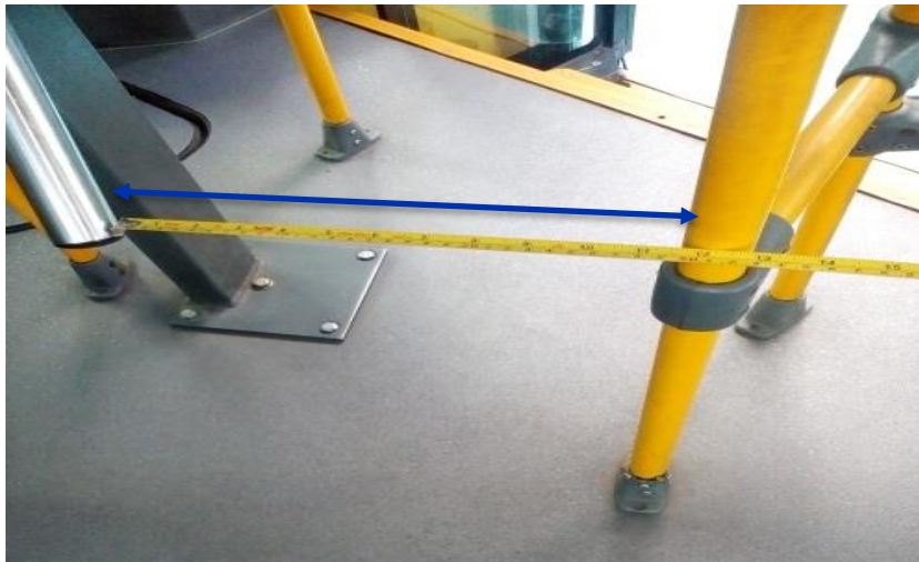
Figura 75. Distancia horizontal promedio 30 Cms BCA en buses
