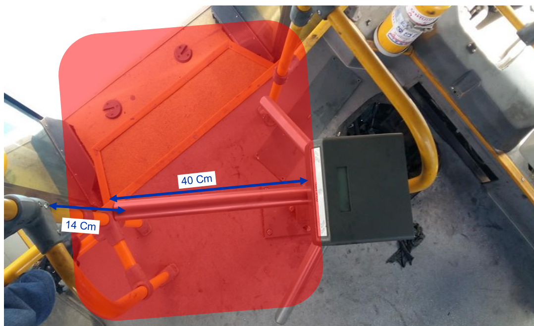
Figura 77. Vista superior vulnerabilidad de la BCA en buses
