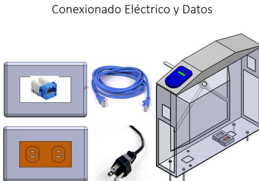
Figura 11. Elementos de conexión BCA portales y estaciones
