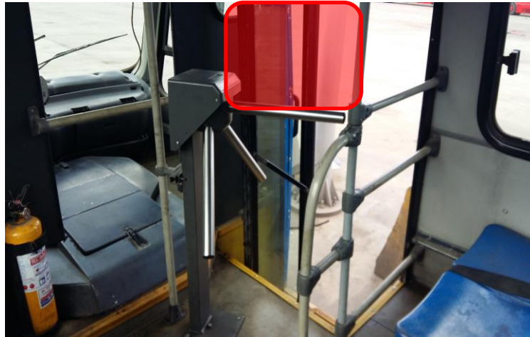
Figura 82. Área superior vulnerable de la BCA en buses
