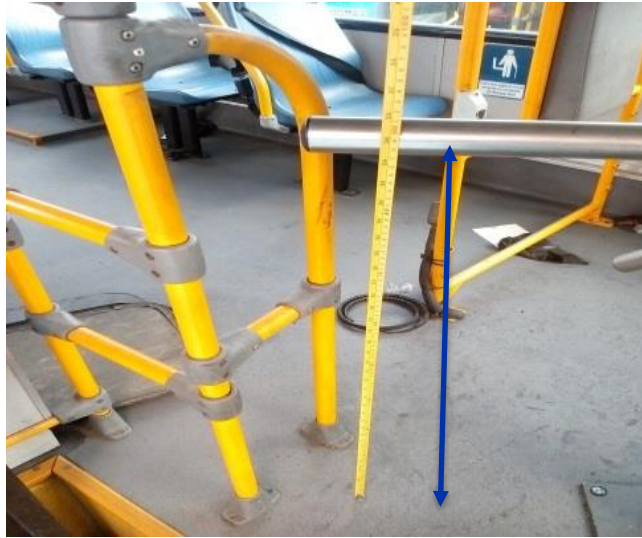
Figura 74. Distancia vertical 90 Cms BCA en buses
