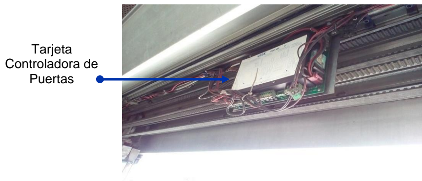
Figura 102. Circuito Controlador de puertas
