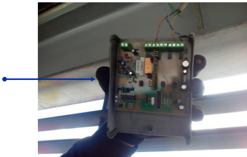
Figura 115. Vista interna del receptor
